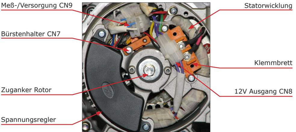
Sollten die Widerstände dem Sollwert entsprechen ist der Stator geprüft und in Ordnung.
